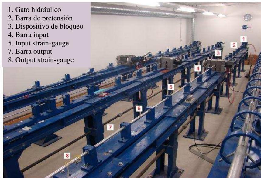
Figura 1: Ensayo MHB (Caverzan et al., 2012)
