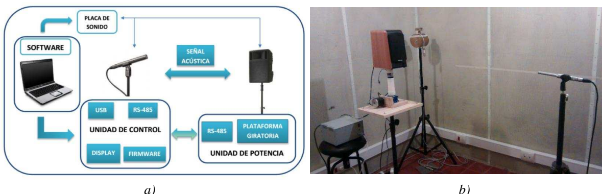
Figura 1: a) Diagrama de bloques del SAMDir v2.0; b) Fotografía del sistema en cámara acústica.
