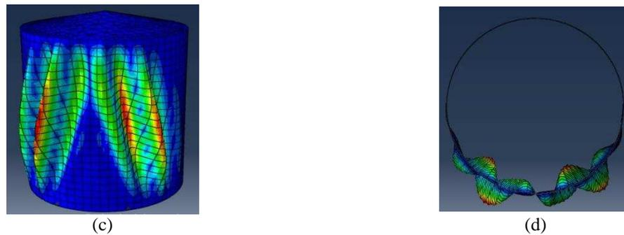
Figura 12: Tanque con Techo Cónico. (a) Modo Crítico de Deformación, Temperatura Constante en altura,  $T_c = 140,28^\circ\text{C}$ , (b) Corte en Planta a 11.43m del piso del modo crítico, (c) Modo Crítico de Deformación, Temperatura Variable en altura,  $T_c = 159.81^\circ\text{C}$ , (d) Corte en Planta a 11.43m del piso del modo crítico
