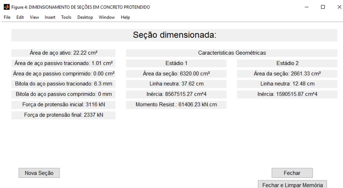
Figura 9: Resultados da seção dimensionada.
