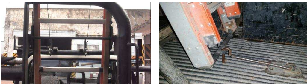
Figura 4: (Izq.) Apoyo 1: sobre barral de camioneta, (der.) Apoyo 2: sobre la caja de la camioneta
