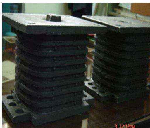
Figura 5: Prototipos de aisladores elastoméricos fabricados en Ecuador.
