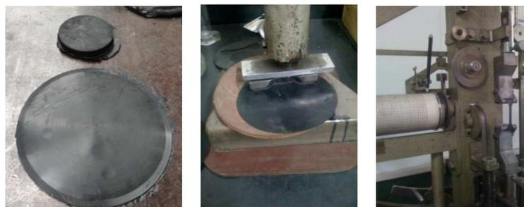
Figura 7: Probetas y ensayos de dureza, tracción y compresión en el material base
