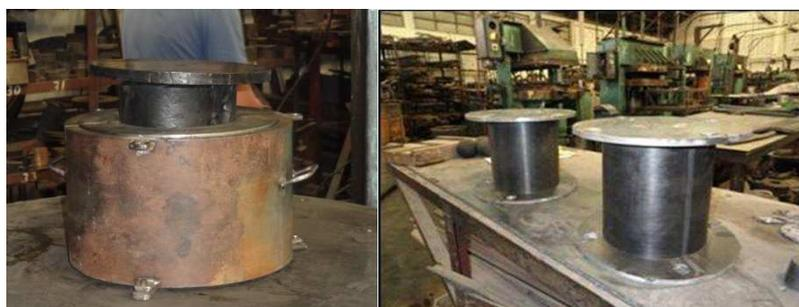
Figura 10: Desmolde de los prototipos
