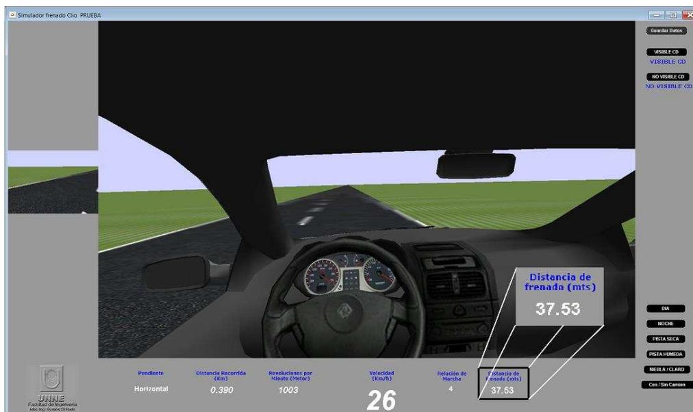
Figura 3.1: Cálculo de distancia de frenado en tiempo real.
