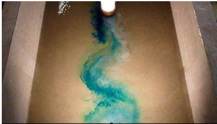
Figure 6.- Visualización del flujo en la interfase de mezcla aguas abajo de la confluencia de flujos paralelos.
