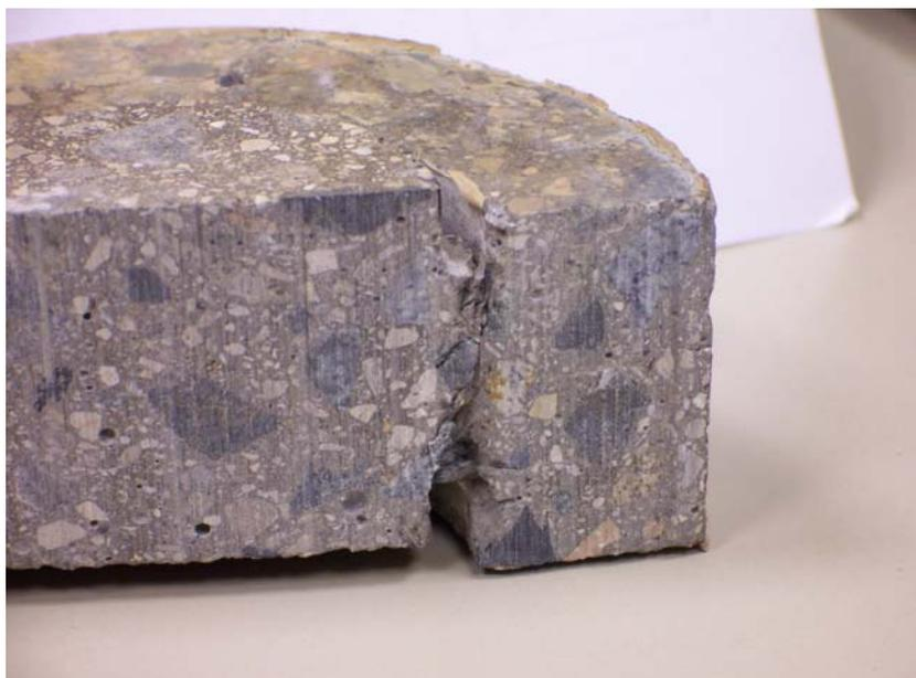
Figura 9. Muestra ensayada (ensayo confinado)
