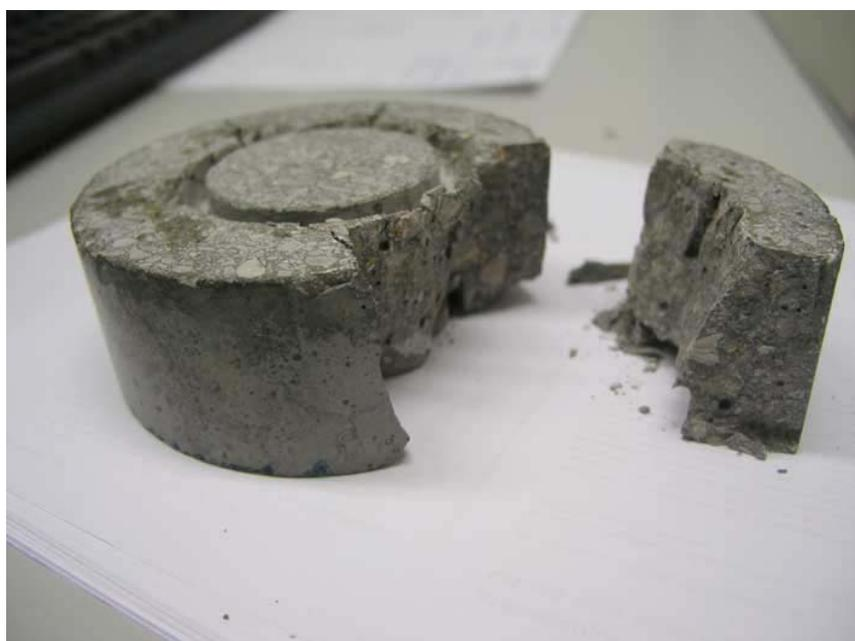
Figura 5. Fisuración en muestra ensayada
