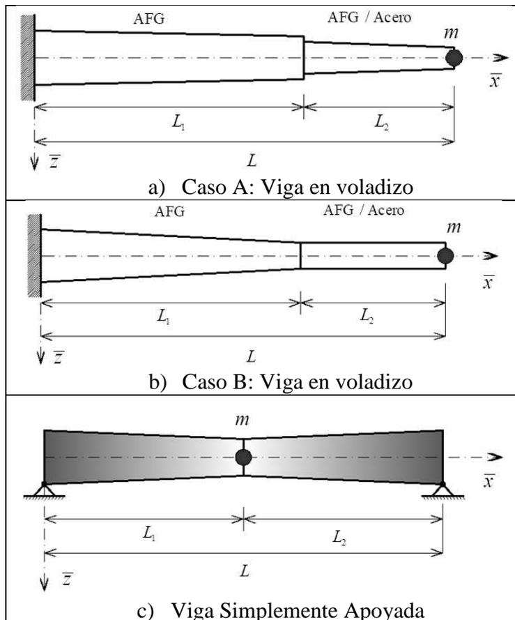
Figura 3: Esquemas de casos propuestos para vigas AFG.
