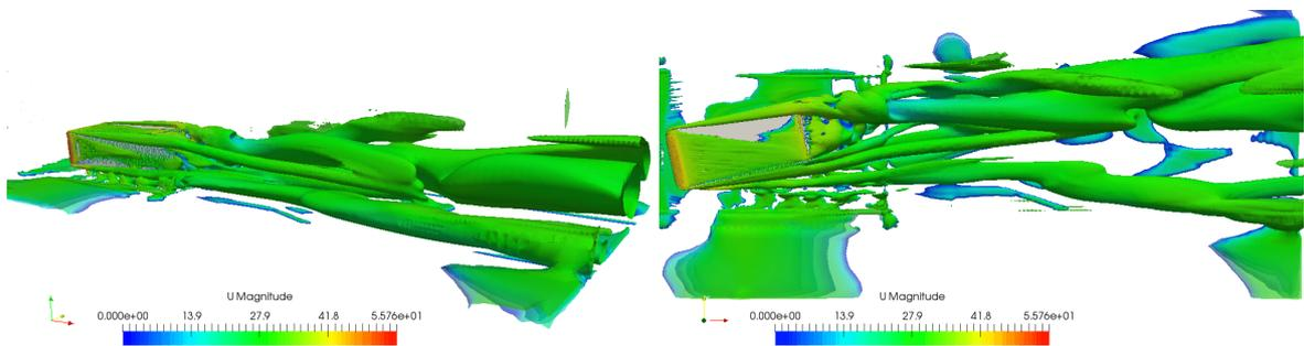
Figura 10: Iso-superficies de  $0 < Q < 100$ , para  $\beta = -12,5^\circ$ .
