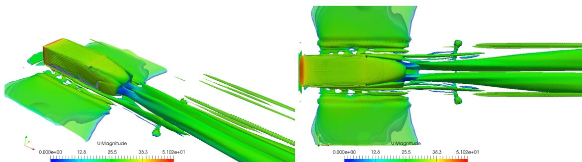
Figura 7: Iso-superficies de  $0 < Q < 100$ , para  $\beta = 0^\circ$ .
