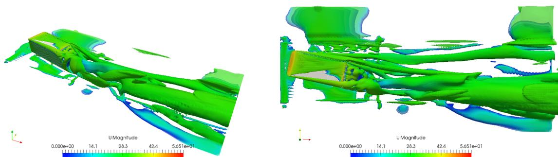
Figura 8: Iso-superficies de  $0 < Q < 100$ , para  $\beta = +12,5^\circ$ .
