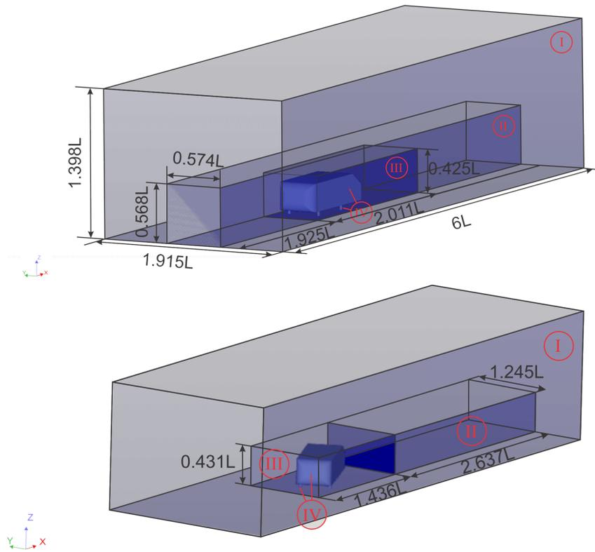
Figura 2: Dimensiones del dominio computacional.  $\beta = 0^\circ$  y  $\beta = -25^\circ$ .
