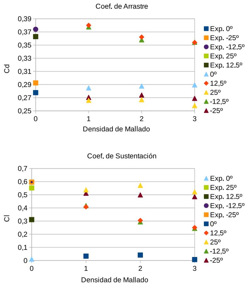
Figura 4: Coeficientes aerodinámicos de arrastre y sustentación.
