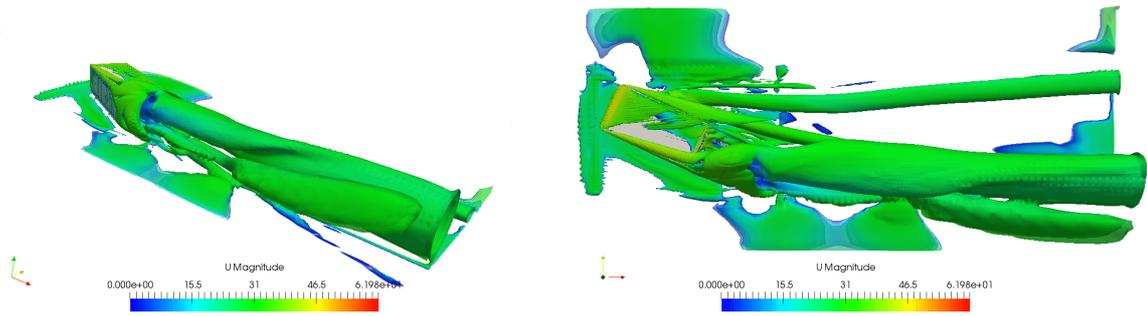
Figura 9: Iso-superficies de  $0 < Q < 100$ , para  $\beta = +25^\circ$ .
