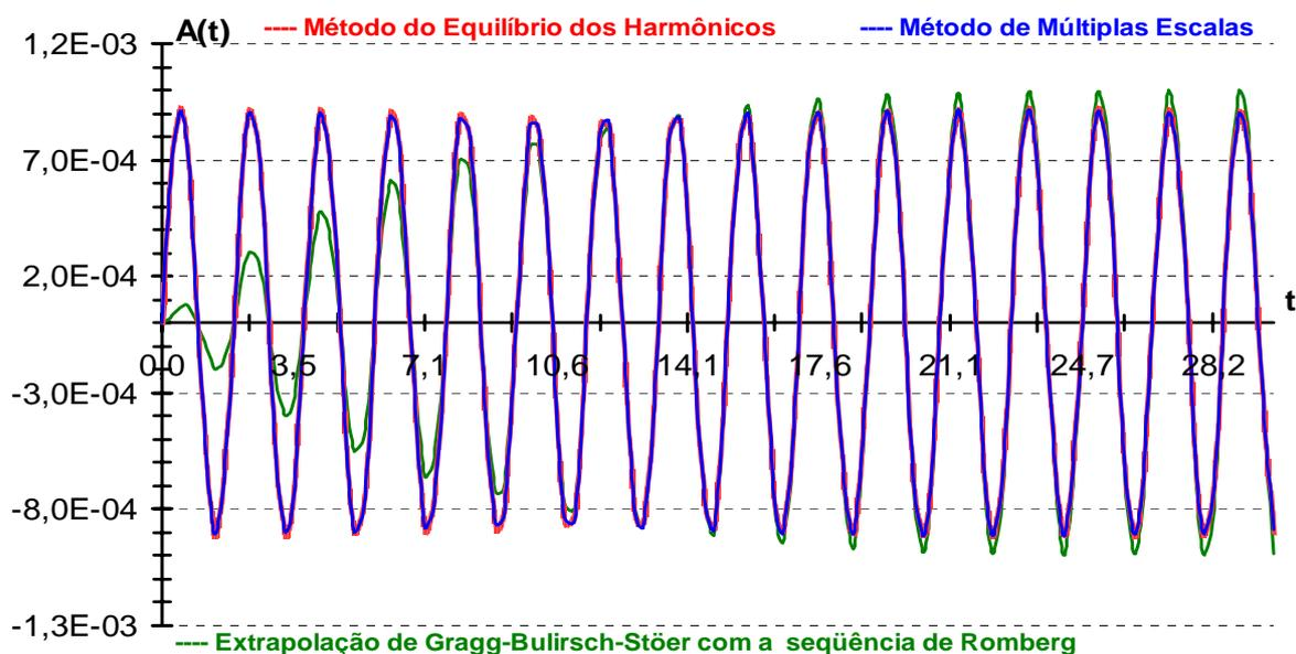
Figura 2. Solução da equação (46) obtida pelo método de Extrapolação de Gragg-Bulirsch-Stöer com a seqüência de Romberg (cor verde), método do Equilíbrio dos Harmônicos (cor vermelha) e método de Múltiplas Escalas (cor azul), sendo  $H = 40\%L$ .
