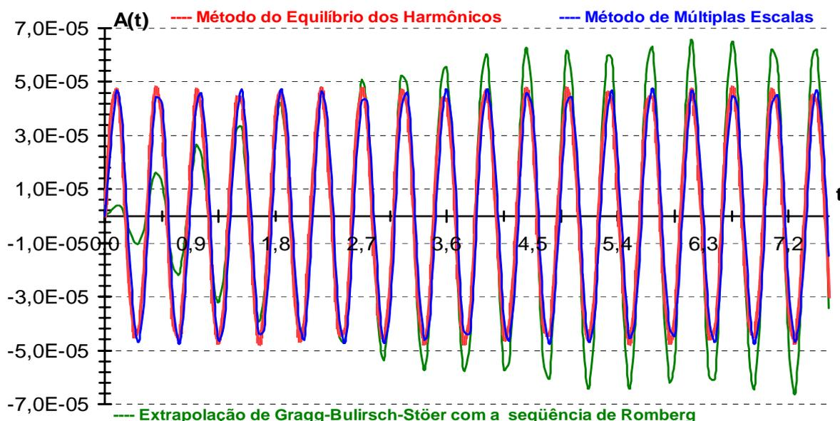
Figura 4. Solução da equação (48) obtida pelo método de Extrapolação de Gragg-Bulirsch-Stöer com a seqüência de Romberg (cor verde), método do Equilíbrio dos Harmônicos (cor vermelha) e método de Múltiplas Escalas (cor azul), sendo  $H = L$ .
