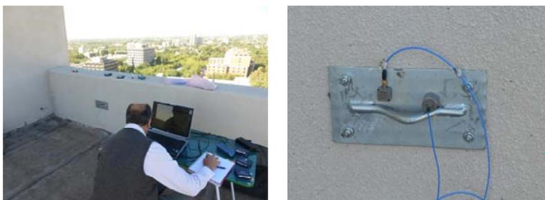
Figura 4: Ensayo de vibración ambiental: Ubicación de acelerómetros
