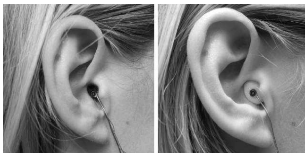
Figura 1: Micrófonos colocados a la entrada del conducto auditivo abierto (izquierda) o bloqueado (derecha). Extraído de Richter (2019).
