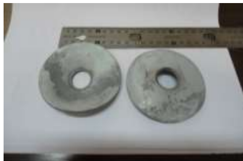
Figura 16. Estado de las arandelas pertenecientes al medio de unión después del impacto del móvil. Fotografía aportada por la Municipalidad de Olavarría.
