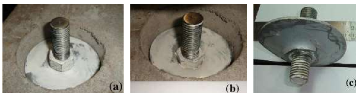
Figura 6. Medio de unión: a) antes del ensayo; b) y c) después del ensayo.
