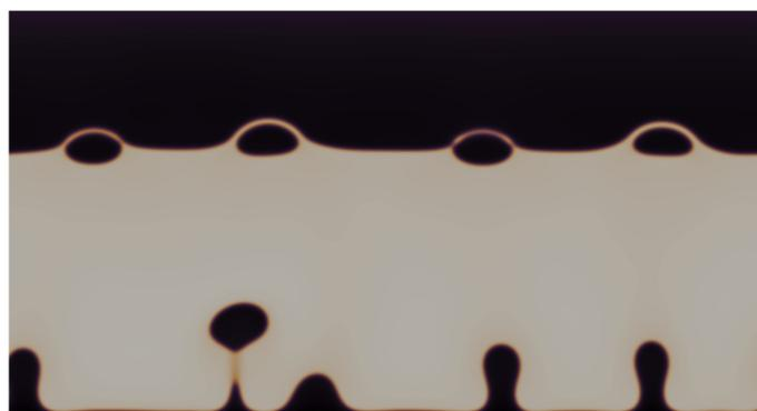
(c)  $t = 120000$ Figura 5: Ebullición sobre placas paralelas.  $T_w = 1,3T_C$ .
