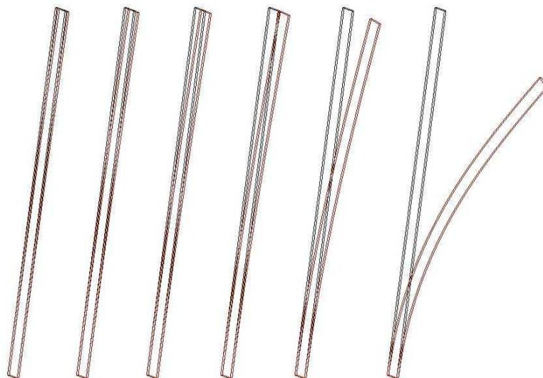
Figura 3: Deformada en los puntos A, B, C, D, E y F respectivamente de la columna, con L=300mm y e=1.667mm.
