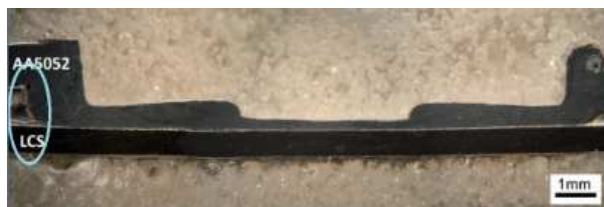
Figura 1: Grandes deformaciones en uniones FSSW disimilares de chapa fina.
