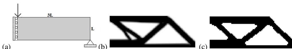
Figura 2: (a) Problema da viga MBB, solucionada pelos métodos (b) SIMP e (c) BESO.
