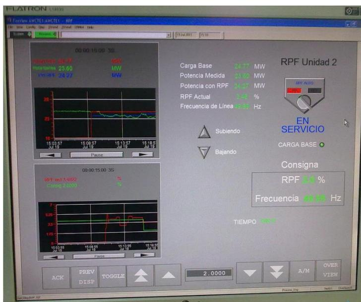
Figura 7: Pantalla del sistema de seguimiento automático de la reserva rotante en tiempo real.
