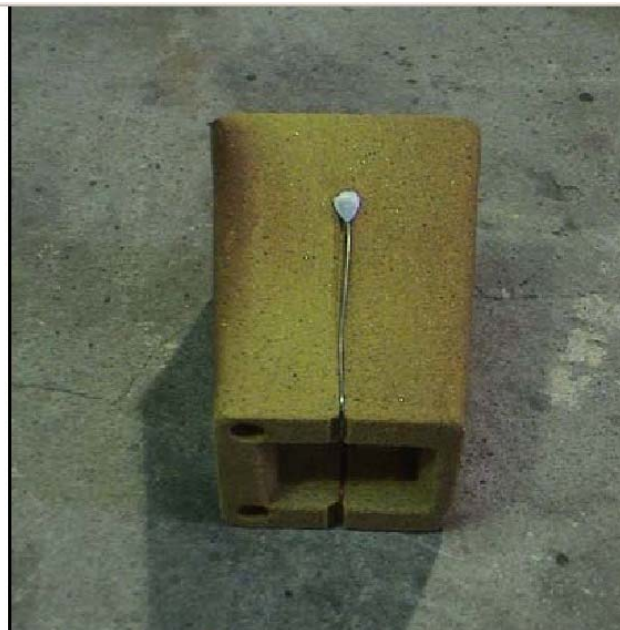
Figura 1: Vistas superior y lateral de la copa Quick-Cup con la termocupla tipo K protegida por un tubo de cuarzo. Foto extraída de Chiarella (2005) .
