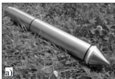
Figura 6: Piezocone utilizado (Salles, 2013).
