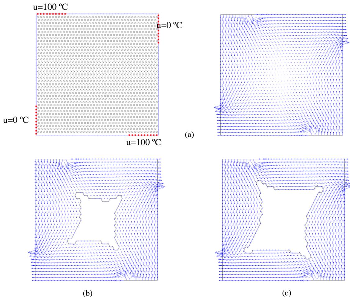
Figura 3: Conductor de calor: (a) geometría y solución de flujo inicial, (b) solución de flujo en la iteración 20, (c) solución de flujo final (iteración 40)
