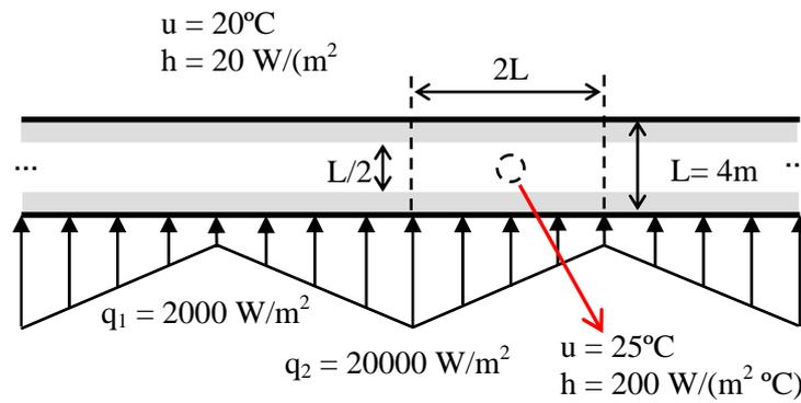
Figura 4: Geometría y condiciones de contorno del intercambiador de calor.
