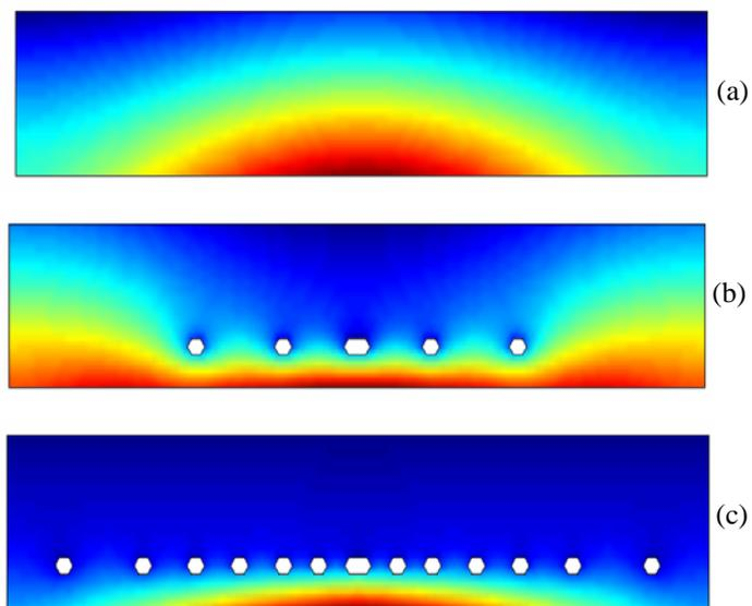
Figura 5: Intercambiador de calor: (a) geometría y solución de temperatura inicial, (b) geometría y solución de temperatura en el paso 3, (c) geometría y solución de temperatura en el paso 7
