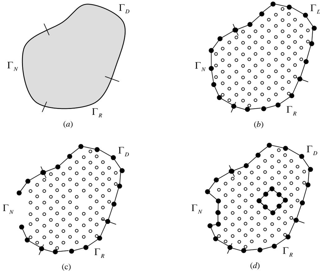
Figura 2: Implementación de la DT: (a) Dominio y condiciones de contorno, (b) Modelo MEC, (c) Eliminación de nodos y puntos internos con los menores valores de DT, (d) Generación de la nueva geometría.
