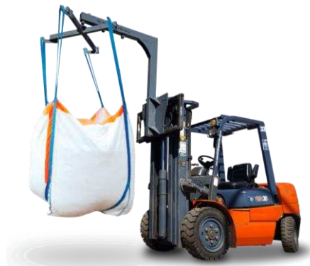
Figura 1: Montacargas utilizando una cruz spreader para cargar el bolsón.
