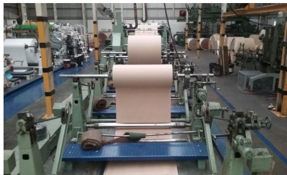
Figura 2: Disposición general de la bobina parcialmente desenrollada en la máquina embolsadora.
