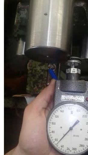
Figura 9: Velocidad en función del diámetro de la bobina y medición con tacómetro de la velocidad.
