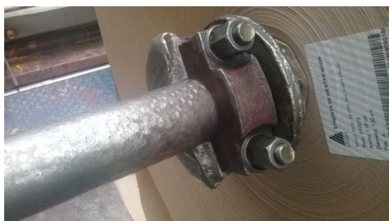
Figura 4: detalle de la sujeción de la bobina al eje mediante una brida y mordaza.
