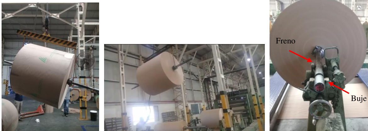
Figura 1: Elevación, transporte y colocación de bobina y eje sobre la máquina embolsadora.
