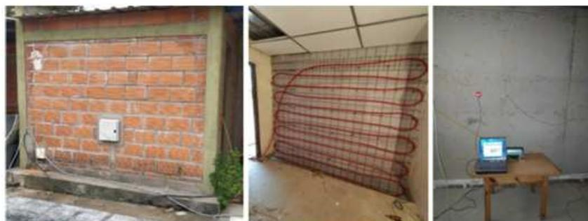
Figura 5: Pared con el sistema APES en casilla experimental del INENCO, (izquierda) vista exterior, (centro) vista interior de la distribución de los tubos y (derecha) monitoreo sobre el tabique terminado.
