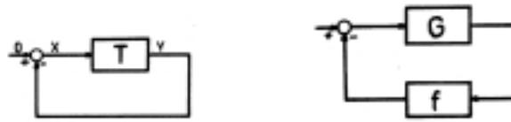
Figura 1: (a) Sistema no lineal realimentado. (b) Estructura standard.
