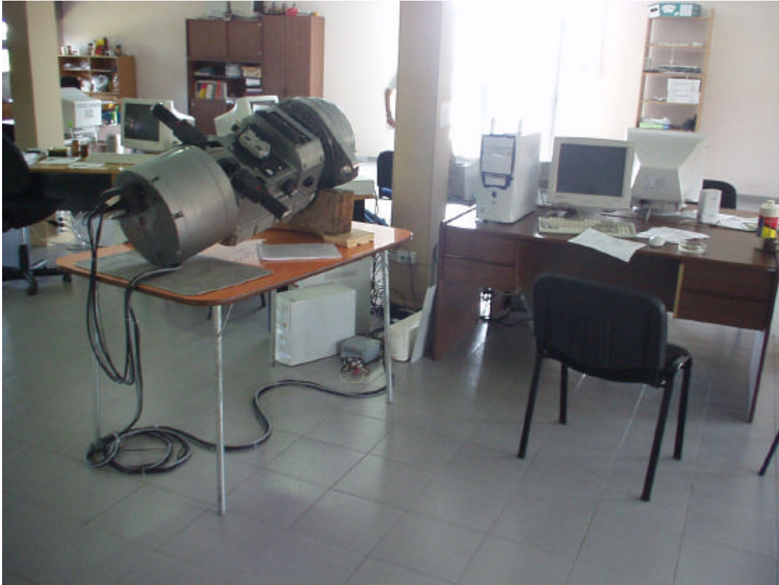
Fig. 3: Hardware del sistema: Unidad de periscopio, lentes, conexiones llevando las ocho señales y computadora encargada de la simulación.
