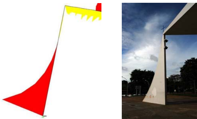
Figura 32: Diagrama de Momentos Fletores – detalhe do Pilar Frontal. Desenho do autor. Programa SAP 2000 e Pilar Frontal da Igreja Nossa Senhora de Fátima. Foto do autor..
