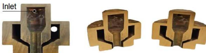
Figura 2: Vista en corte del inyector estudiado.
