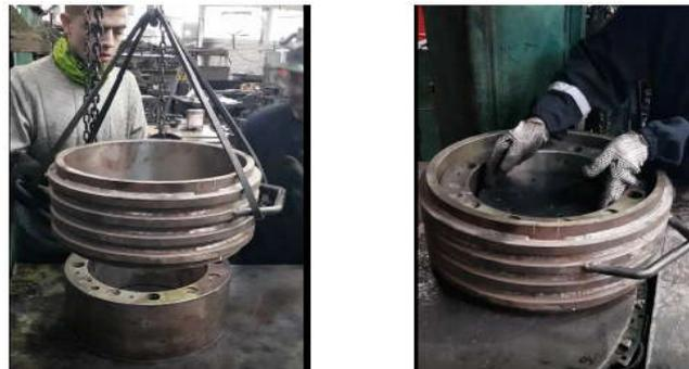
Figura 3. (a) Cilindro interior y exterior del molde; (b) cilindros del molde acoplados.
