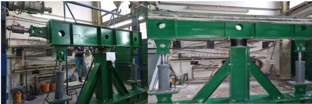
Figura 5. Fotografías del aparejo de carga para ensayo de aisladores sísmicos de 2ª generación.
