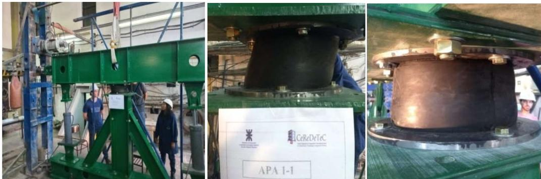
Figura 6. Fotografías los ensayos a cargas horizontales de los aisladores sísmicos de 2ª generación.
