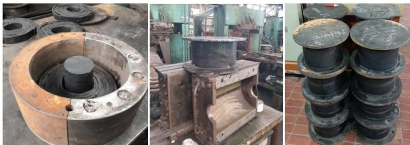
Figura 4. Moldeo manual del dispositivo y dispositivos desmoldados.
