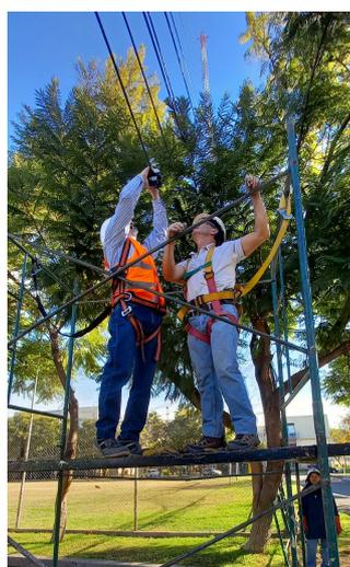
(b) Posicionamiento de acelerómetro.
