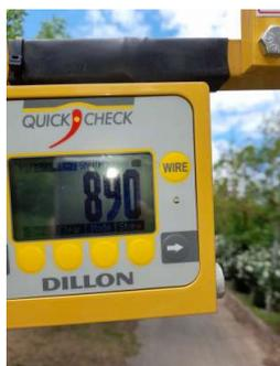
Figura 6: Medición directa del estado tensional en una de las riendas.
