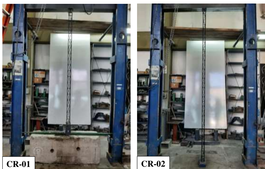
Figura 5: Columnas armadas previo a ser ensayadas a compresión.
