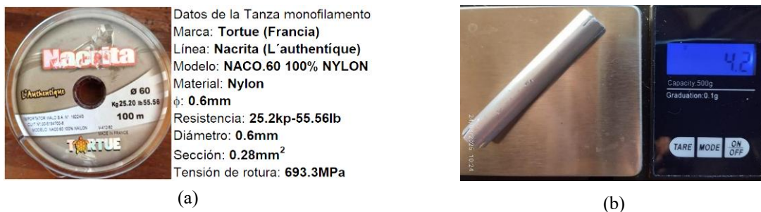
Figura 4. Materiales utilizados. a) Propiedades del monofilamento, b) Puntal con indicación de su peso.
