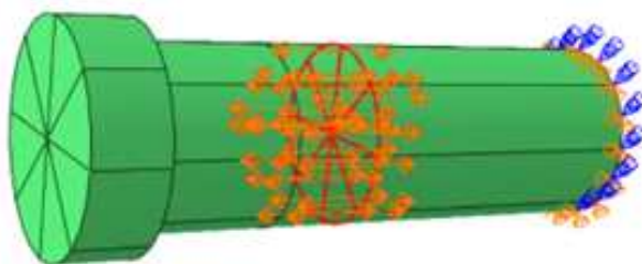
Figura 3: Definición de la precarga en una sección interna del bulón
