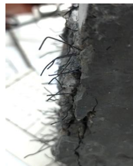
Figura 3: Fibras en la superficie de falla.
