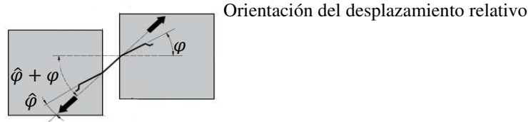
Figura 1: Cambio de orientación de una fibra en la fisura
