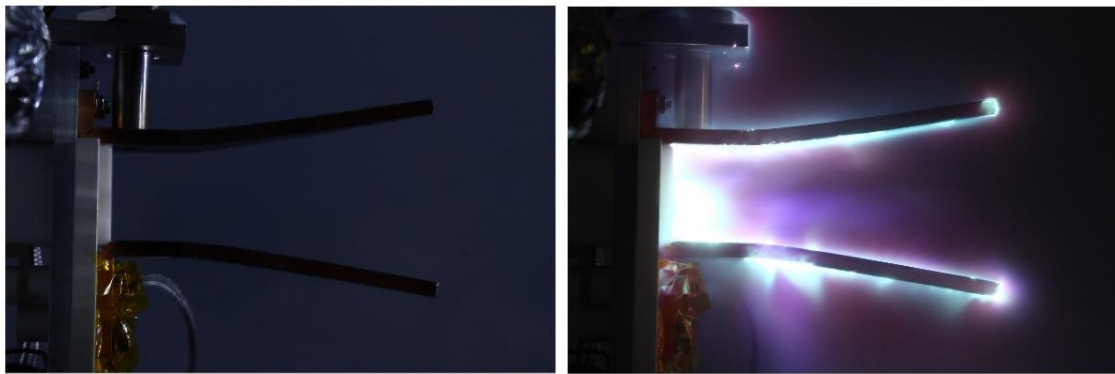
Figura 2: APPT experimental montado dentro de la cámara de vacío. A la izquierda se muestra el propulsor instantes previos al disparo, a la derecha la foto es tomada durante el disparo del propulsor.
