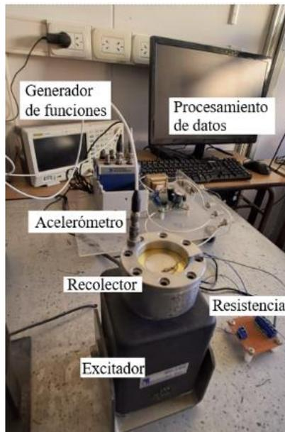
Figura 3. Esquema de ensayo en laboratorio.
