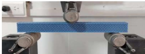
Figura 5: Pieza con 92 % de densidad de relleno antes de ser cargada.
