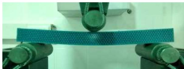
Figura 6: Pieza con 92 % de densidad de relleno durante el proceso de carga.
