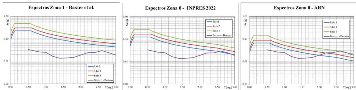
Figura 3: Espectros determinados para las tres aceleraciones del suelo consideradas: i) Bexter et al (igual al espectro de la zona 1); ii) Mapa INPRES 2022 y iii) ARN probabilístico.
